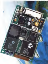
▲ Posizionamento globale: un sistema Global Positioning System (GPS) usa satelliti in orbita per stabilire la longitudine, latitudine, altezza e velocità di un particolare oggetto. Recentemente i fabbricanti hanno integrato questa tecnologia nelle PC Card, rendendo di fatto i «mobile computer» capaci di gestire applicazioni basate sulla posizione, quali la navigazione, posizionamento di veicoli e rilevazioni.
